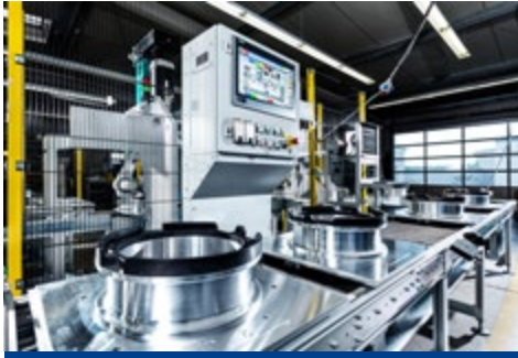
manuelle Beladung des Gehäuses auf spezielle Werkstückträger
