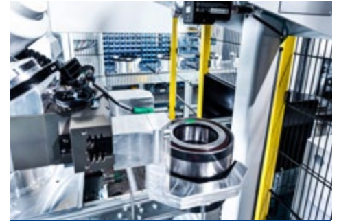
Entnahme der Lager via Roboter sowie automatische DMC-Lesung bei jedem Einbauteil
