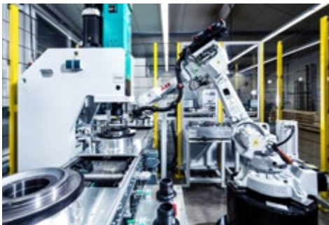
Positionierung des Lagers zur Temperaturmessung
