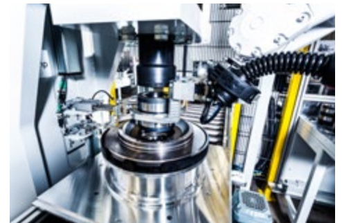
bei Temperaturunterschied <2^{\circ}\text{C} : Einpressvorgang mit bis zu 150 kN
