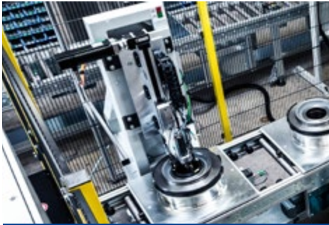
Überprüfung der Durchmesser in verschiedenen Bohrungstiefen
