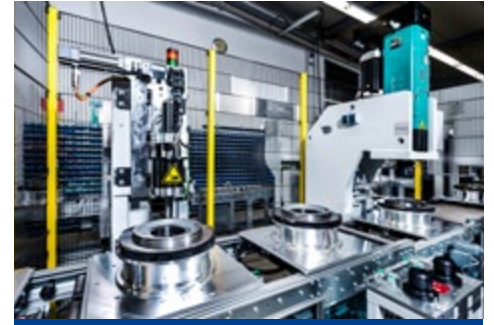
Einlauf in Messstation mit DMC-Leser und DIATEST-Messsystem
