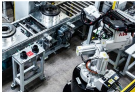
bei Temperaturunterschied >2^{\circ}\text{C} zwischen Werkstück & Lager: Positionierung des Lagers auf n.i.O.-Ablage
