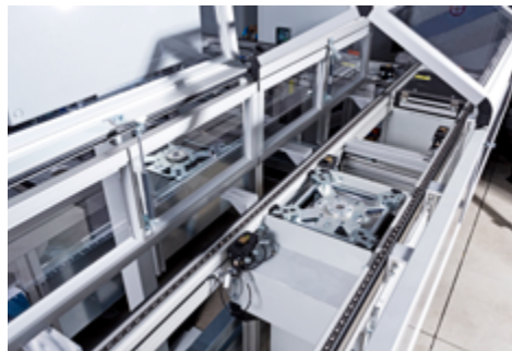
Kühltunnel inkl. Abdeckungen mit Zugriffsmöglichkeit
