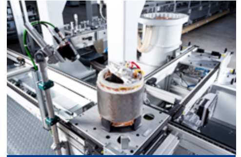
Kamera-Lagekontrolle des Stators
