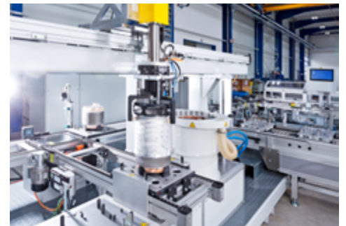
anschließender Fügeprozess mit Kraft-/Wegüberwachung
