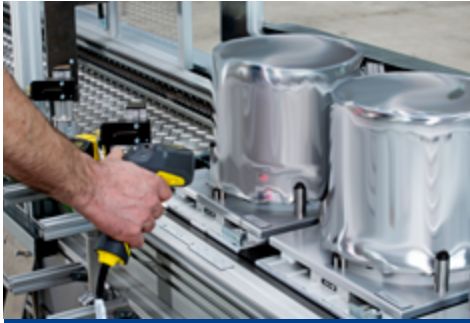
Übernahme Bauteil von Vormaschine, ggf. Einschleusung von Nacharbeitsteilen mittels DMC-Handscanner
