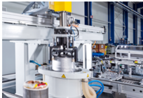
induktive Erwärmung des Gehäuses
