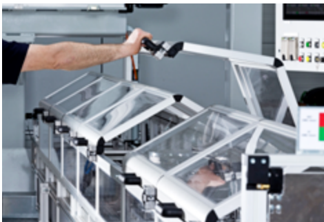
Ausschleusung n.i.O.-Teile mit Entnahmemöglichkeit nach Abkühlzeit
