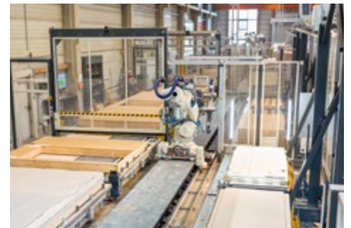
Zellenwechsel zu Gipsbauplattenzelle
