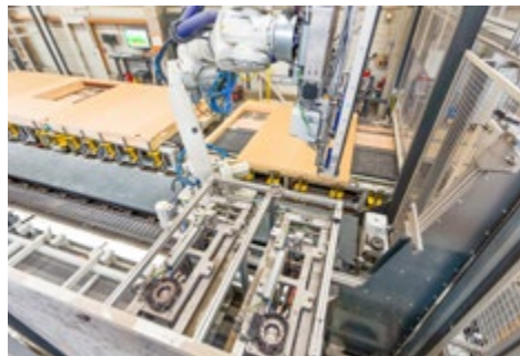
erneuter Greiferwechsel von Klammergerät zu Sauggreifer
