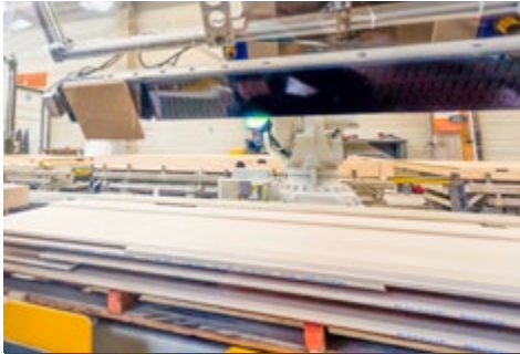
Erkennung und Ausschleusung von prozessbedingten Füllstücken
