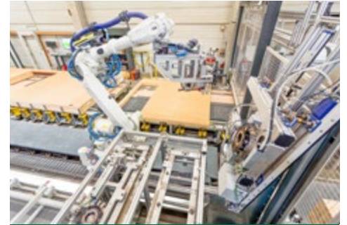
automatischer Greiferwechsel des Roboters von Sauggreifer zu Klammergerät
