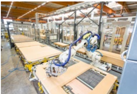
Klammern der Platten mit definierten Klammerbahnen und -winkeln
